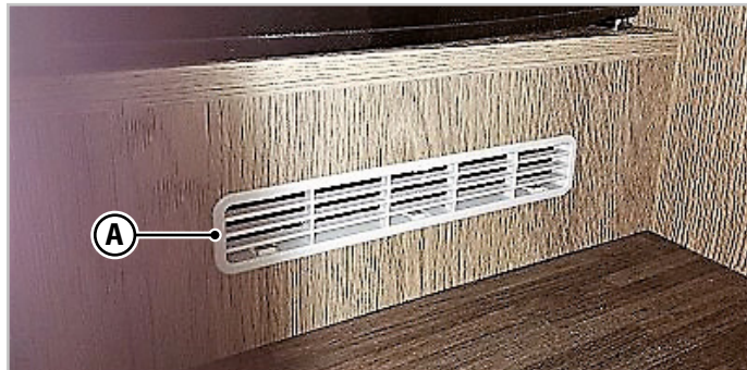
Joon.6.1 - Püsivad ventilatsiooniavad
