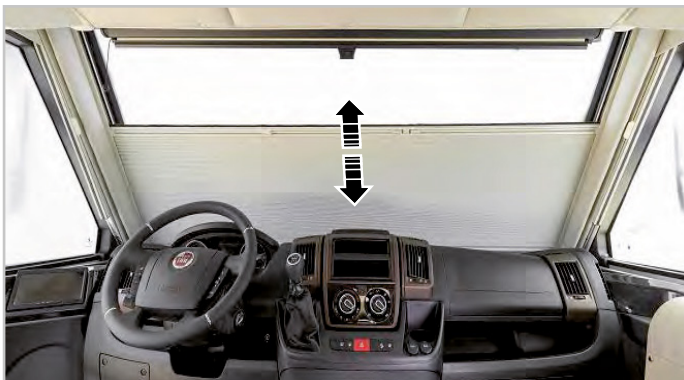
Afb.6.12 - Opvouwbare zonneschermen voor de voorruit
