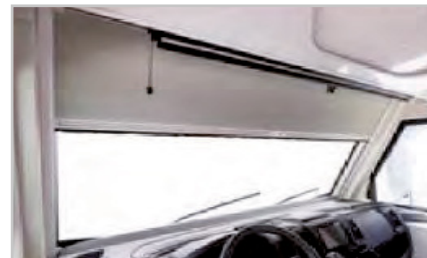
Afb.6.13 - Posities van de zonneschermen voor de voorruit
