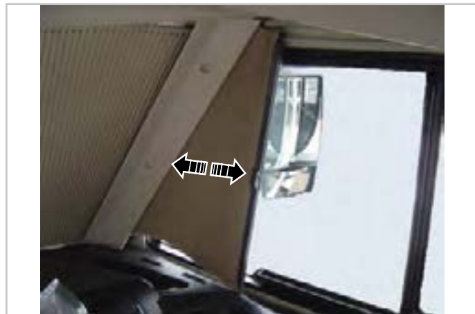
Фиг.6.11 - Сгъваеми затъмняващи щори за страничните прозорци
