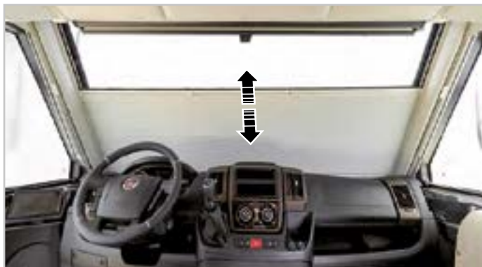
Фиг.6.12 - Сгъваема затъмняваща щора за предно стъкло
