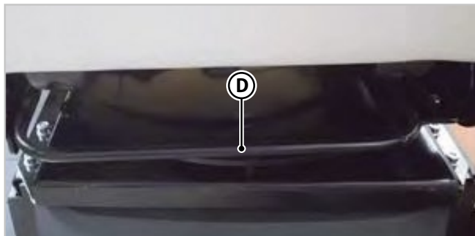
Fig.3.7 - Levier de coulissement du siège
